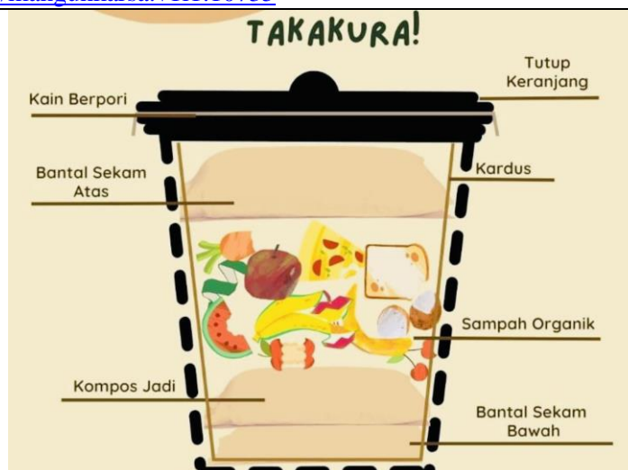
Gambar 3. Gambaran Keranjang Takakura dalam Pengolahan Sampah Organik Menjadi Kompos (Riyandini et al. , 2023)
